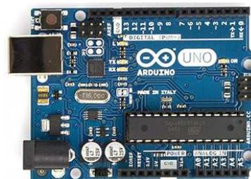
Ce microcontrôleur peut être programmé pour analyser et produire des signaux électriques, de manière à effectuer des tâches très diverses pour le pilotage de divers équipements.
